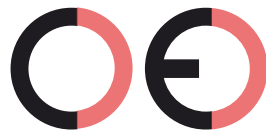
Virheellinen CE-merkki (liian kaukana)
