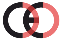
Virheellinen CE-merkki (liian lähellä)
